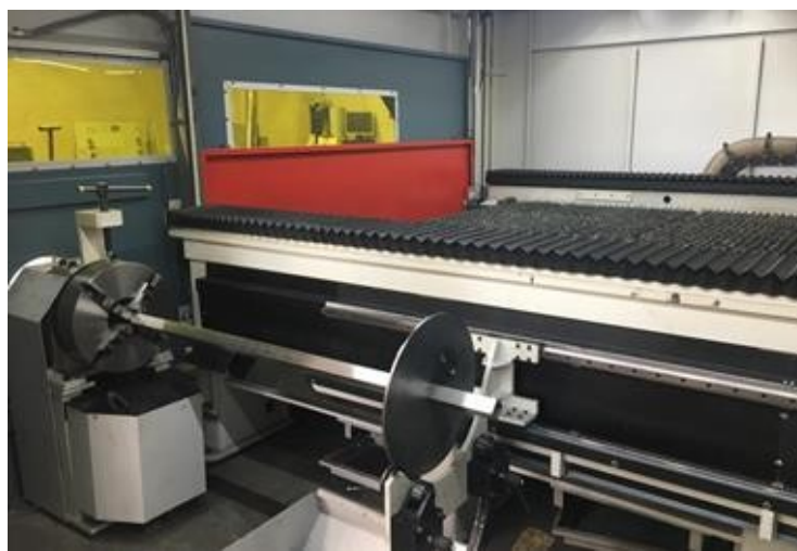
De extra rotatie-as maakt het lasersnijden van buizen mogelijk
